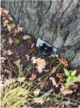
9 : Un des deux inclinomètres pour la mesure de stabilité du plateau racinaire
